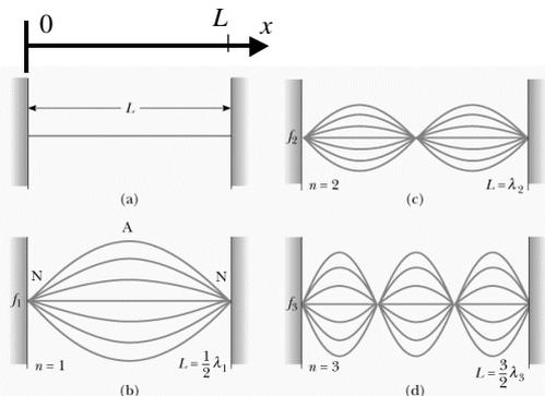
每一個 $n$ 值的振動形式稱做一個振動模態(normal mode)
