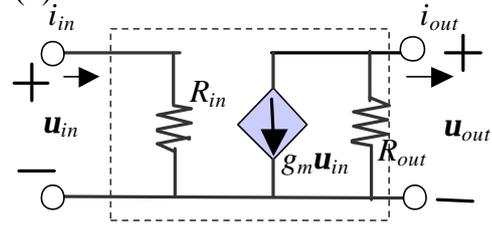
$$R_{in}=10\text{k}\Omega, g_m=10\text{A/V}, R_{out}=100\text{k}\Omega$$
